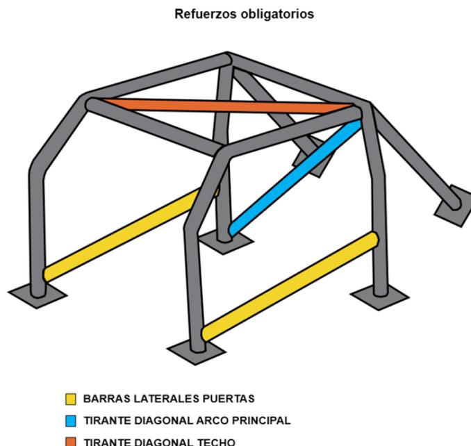
**Nota:** la obligatoriedad de incorporar los tirantes de refuerzo diagonales en techo y arco principal sólo aplica a vehículos de nueva inscripción cuya estructura de seguridad se fabrique de forma artesanal. Vehículos con estructuras con homologación FIA o de marcas o fabricantes reputados están exentas de incorporar estos refuerzos.
