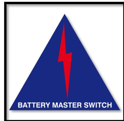
La situación del cortacorrientes debe estar claramente indicada mediante una pegatina con forma de triángulo de fondo azul con base de, al menos, 12 cm, con reborde blanco y un relámpago rojo. La posición OFF del mando del cortacorrientes deberá estar claramente indicada.
