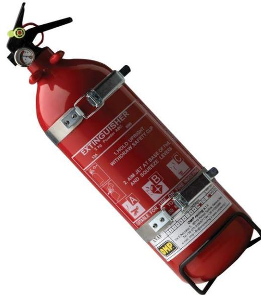
El extintor debe estar firmemente sujeto al vehículo mediante pernos y tuercas y en ningún caso mediante tornillos directamente sobre la chapa. El extintor deberá estar perfectamente sujeto, pero dispondrá de una fijación de apertura rápida que permita su utilización en caso de emergencia. Solo se aceptan las fijaciones metálicas de desprendimiento rápido con abrazaderas metálicas (dos como mínimo, ver imagen).
